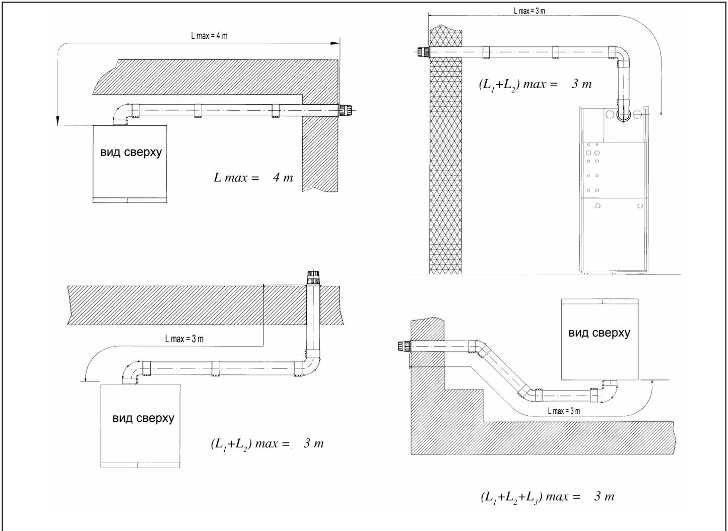
Примеры установки с отводом продуктов сгорания в общий дымоход (тип LAS)
