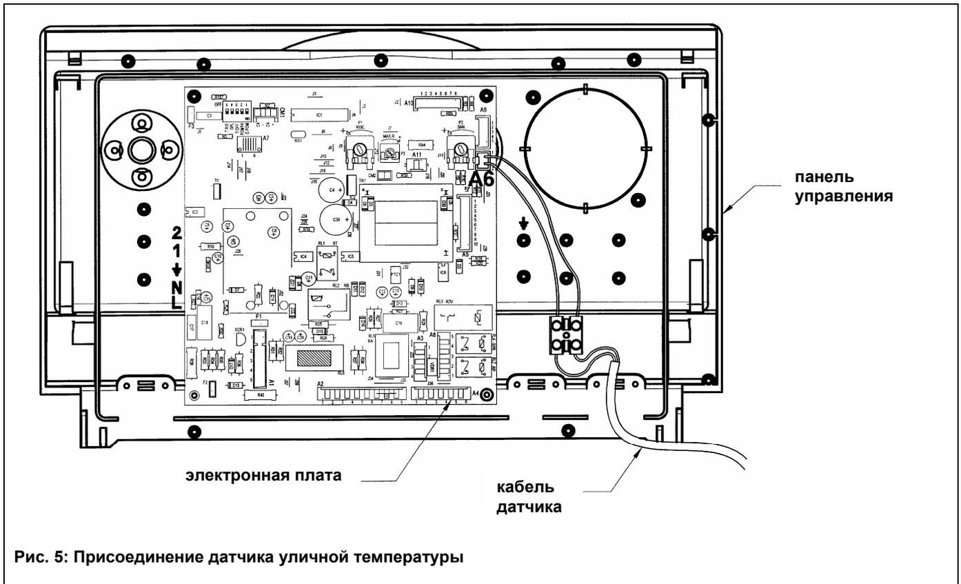
Рис. 5: Присоединение датчика уличной температуры
