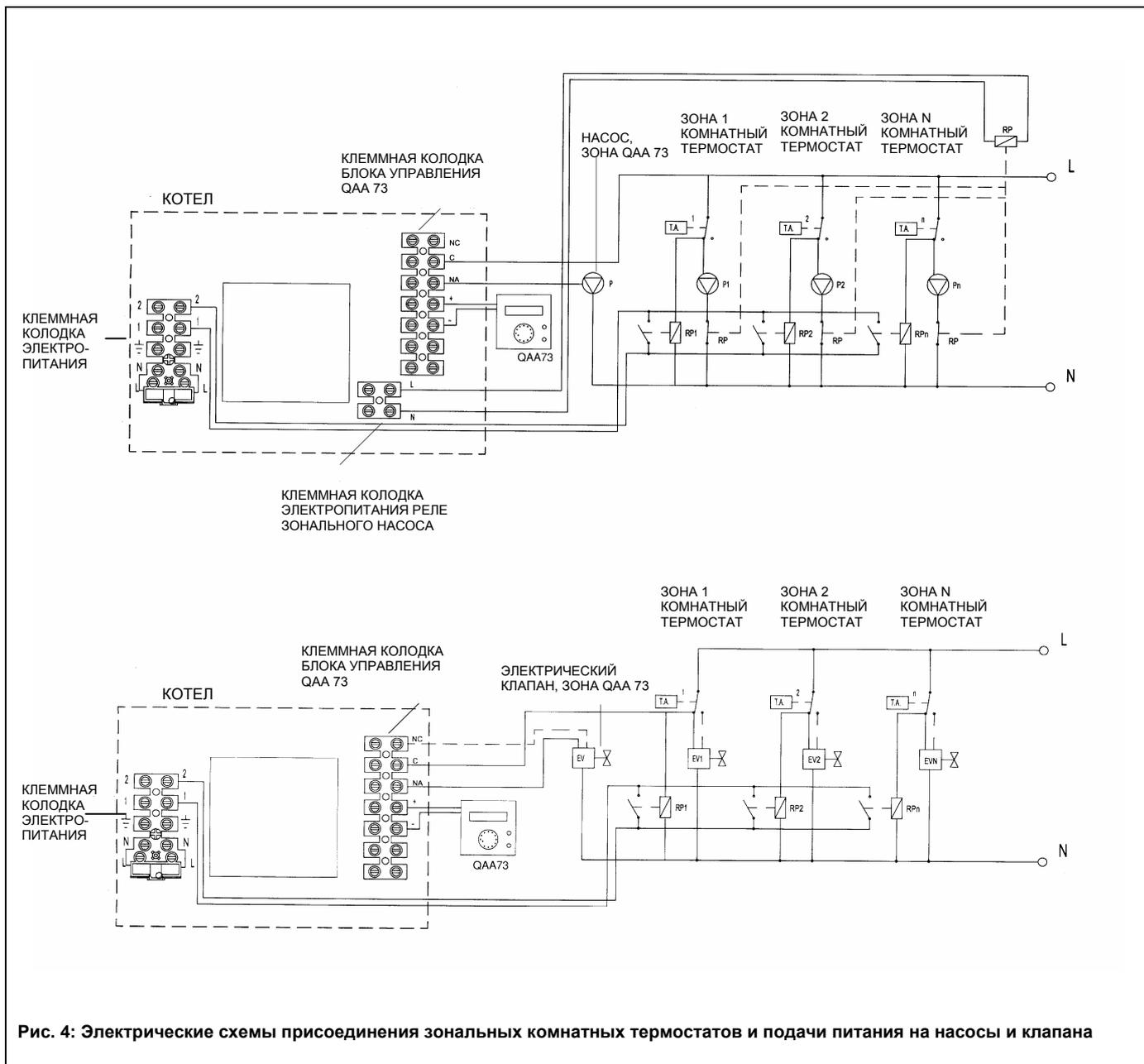
Рис. 4: Электрические схемы присоединения зональных комнатных термостатов и подачи питания на насосы и клапана
