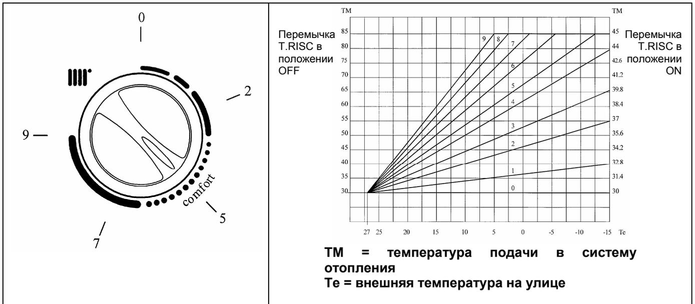
**Внимание:** Значение температуры подачи в систему отопления  $T_m$  зависит от положения переключателя T.RISC на плате (см. § 13). Максимальное значение устанавливаемой температуры равно 85 или 45 °C (по умолчанию установлено 85°C).
