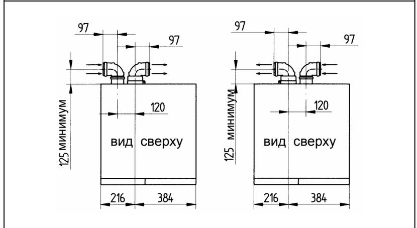
**Примеры установки с горизонтальными раздельными трубами**
