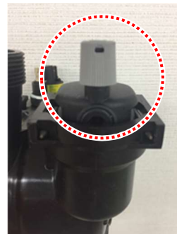
< Крышка вентиляционного отверстия открыта >
