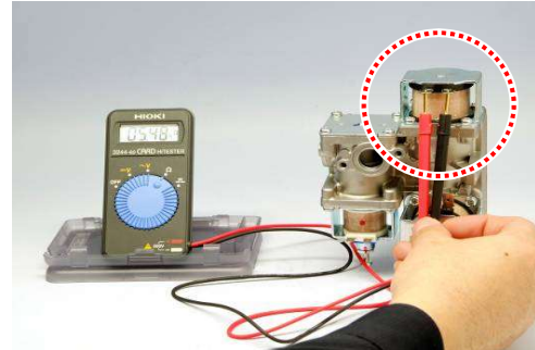
<Замер сопротивления 2-го соленоидного клапана>
