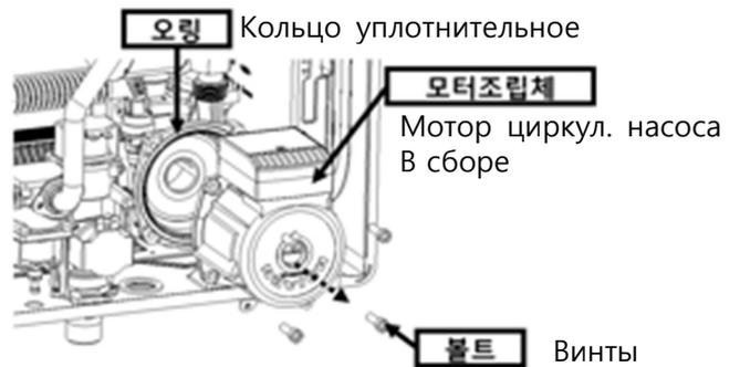
Крышка циркуляционного насоса(A/S) фиксируется на корпусе при помощи 4 болта. Снимите его и вы получите доступ к «внутренностям» насосного оборудования.
