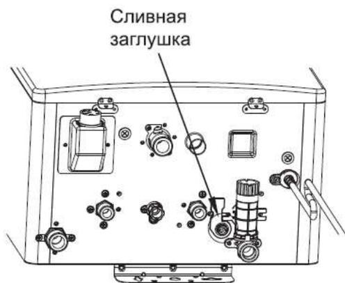
необходимо подождать пока котел остынет! Поворачивая фильтр против часовой стрелки, извлеките его из котла.
