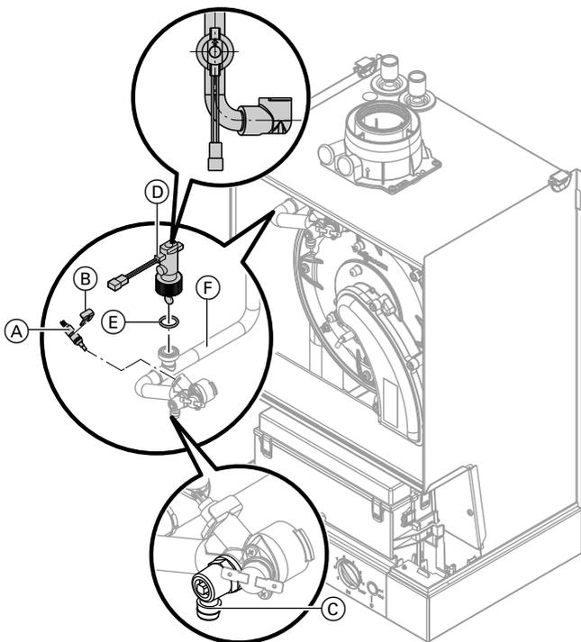
1. Закрыть отопительный контур водогрейного котла и в максимальной возможной степени опорожнить линии.
