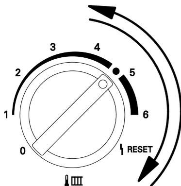
Повернуть ручку настройки "III" в пределах не более 2 с в положение "I RESET", а затем снова вернуть в диапазон регулировки.
