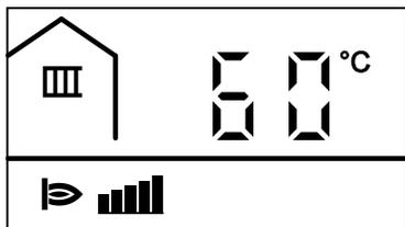
Температура котловой воды во время работы постоянно отображается на дисплее.
