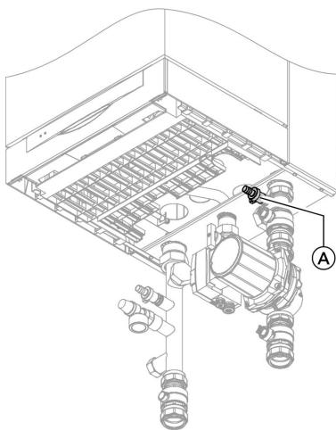
1. Проверить входное давление мембранный расширительного бака.
