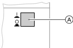
1. Выключить сетевой выключатель (A) на комплекте привода смесителя и снова включить. Прибор выполняет следующую самопроверку:
