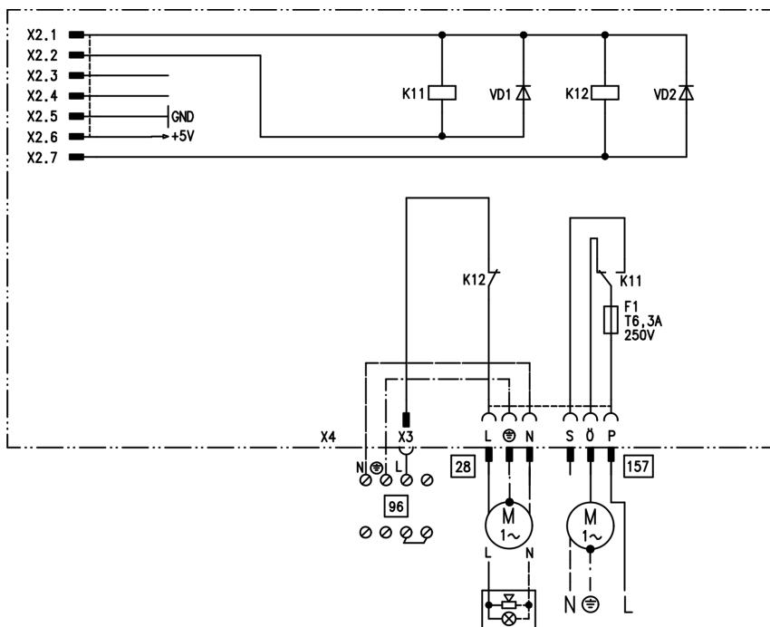
Внутренний модуль расширения монтируется в корпусе контроллера. К релейному выходу [28] могут быть подключены по выбору приведенные далее функциональные устройства. Назначение функции осуществляется кодовым адресом "53":
