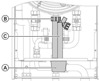
1. Снять колпачок (A), потянув вниз.
