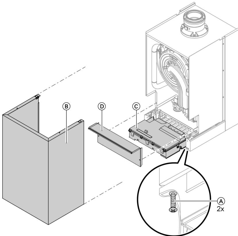
1. Отпустить винты (A) с нижней стороны и снять передний щиток (B).
