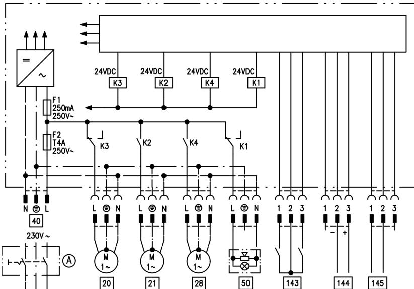
Внешний модуль расширения подключается через шину KM к контроллеру водогрейного котла. При помощи модуля расширения можно одновременно управлять указанными далее устройствами:
