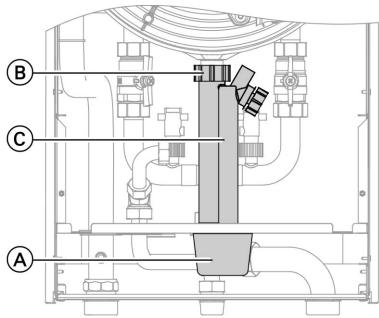
1. Снять колпачок **A**, потянув вниз.
