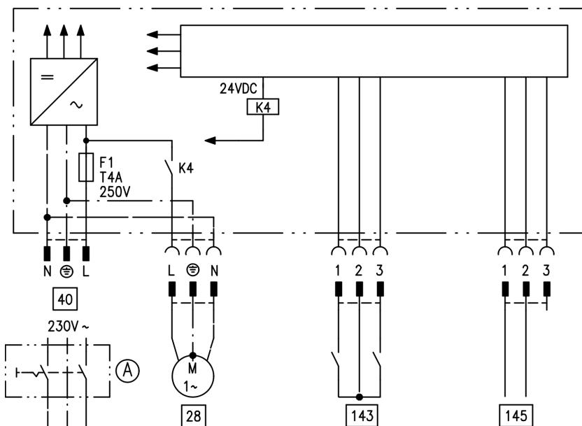
Внешний модуль расширения подключается через шину KM к контроллеру водогрейного котла. При помощи модуля расширения можно одновременно управлять указанными далее устройствами:
