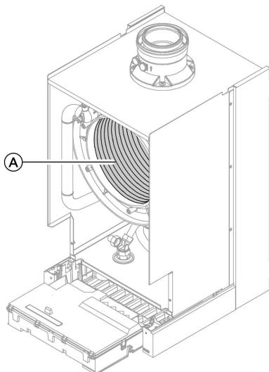
1. Отсосать накипь с теплообменных поверхностей **(A)** камеры сгорания.
