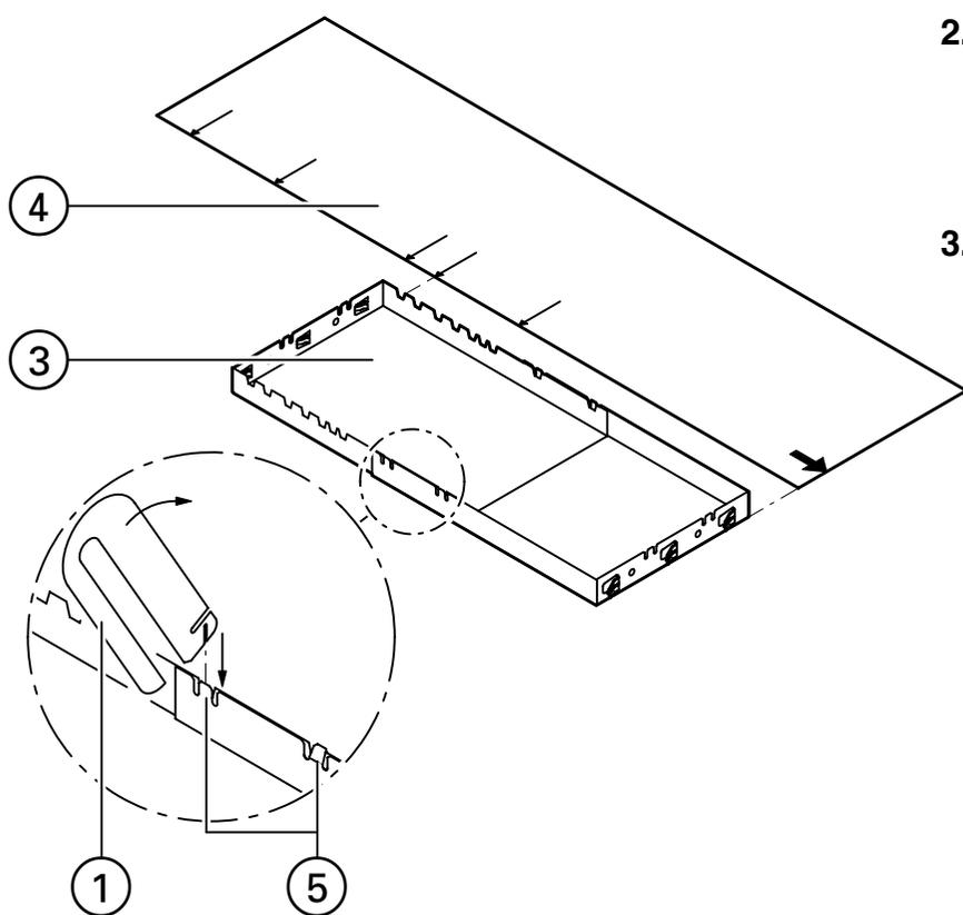
2. Раздвинуть боковые щитки ③ и с помощью картонного шаблона ④ отрегулировать в соответствии с размером котла.
