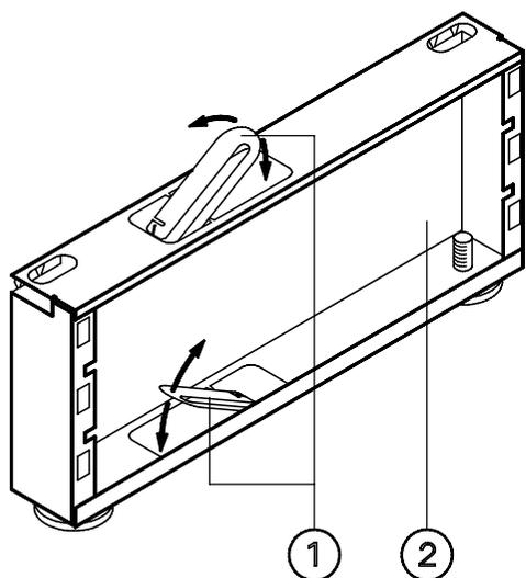
1. Вынуть четыре монтажных ключа ① (понадобятся впоследствии в качестве подкладных шайб) из деталей рамы ②.
