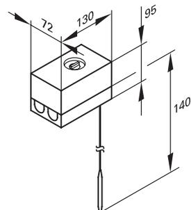
С термостатической системой, без погружной гильзы (погружная гильза входит в комплект поставки емкостного водонагревателя).
