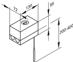
С термостатической системой, без погружной гильзы.
