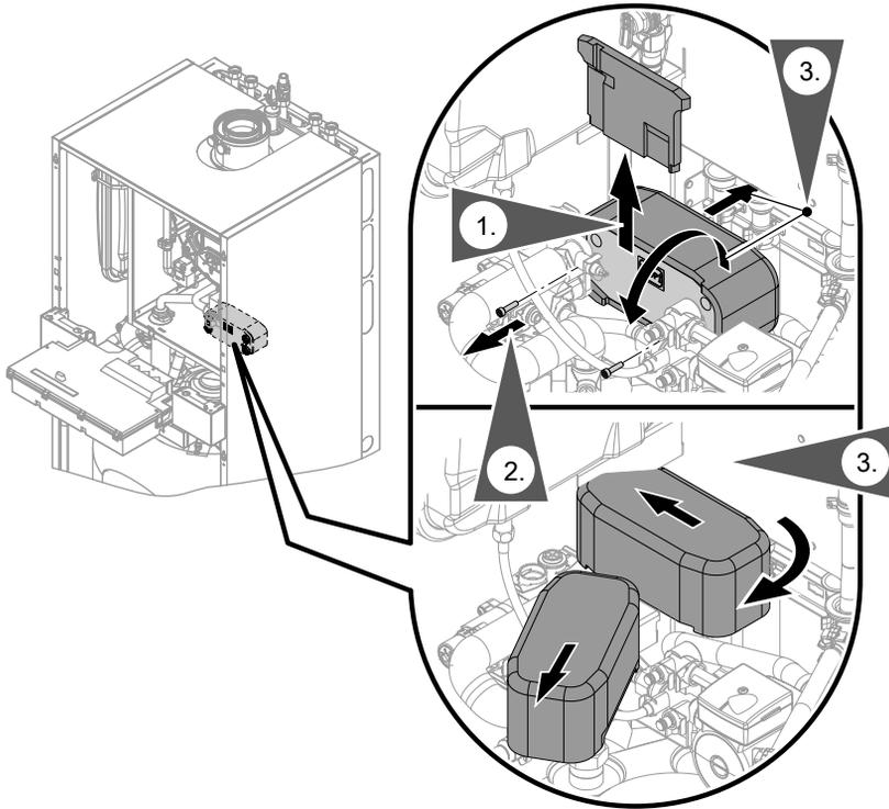
1. Вынуть теплоизоляционную панель по направлению вверх.
