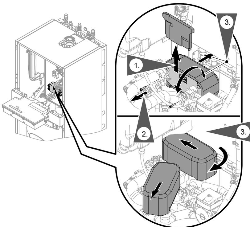
1. Вынуть теплоизоляционную панель по направлению вверх.
