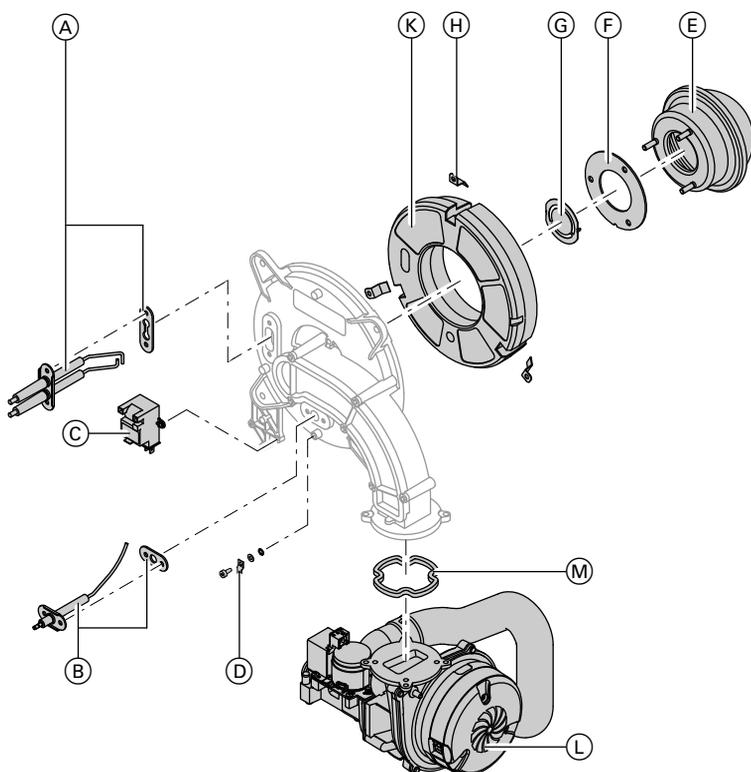
1. Открутить два винта и демонтировать поджигающий электрод (А) с уплотнением.
