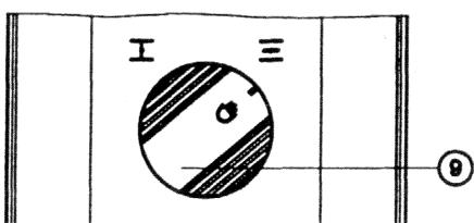
Вдавить поворотную ручку ② и через положение “III” повернуть ее до упора.
