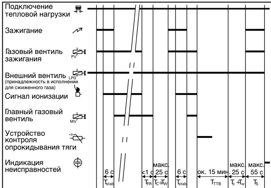
$T_{stab}$  Время стабилизации растопочной форсунки
