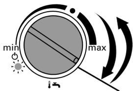
2. Установить верхний предел тепловой мощности. Повернуть ручку регулятора "☀️🔥" вправо до упора (оставить на короткое время в этом положении) и затем обратно. Светодиодные индикаторы "☀️🔥" и "☀️🔥🔥" одновременно мигают.
