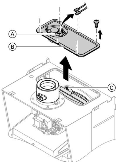
1. Отсоединить провода от реле давления (A).
