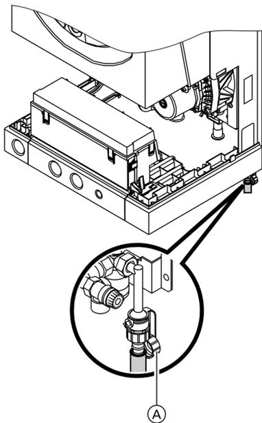
1. Проверить давление на входе мембранного расширительного сосуда.
