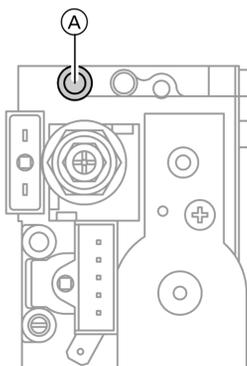
3. Ослабить, не вывинчивая, винт в измерительном патрубке **A** и подсоединить манометр.
