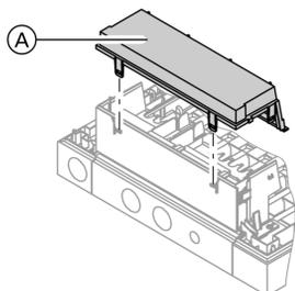
1. Отсоединить и снять крышку соединительной коробки (A).
