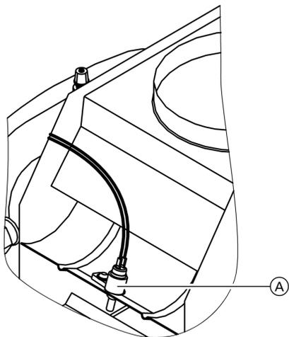
5. Если отключение устройством контроля опрокидывания тяги произойдет позже чем через 5 минут, проверить положение датчика (A).
