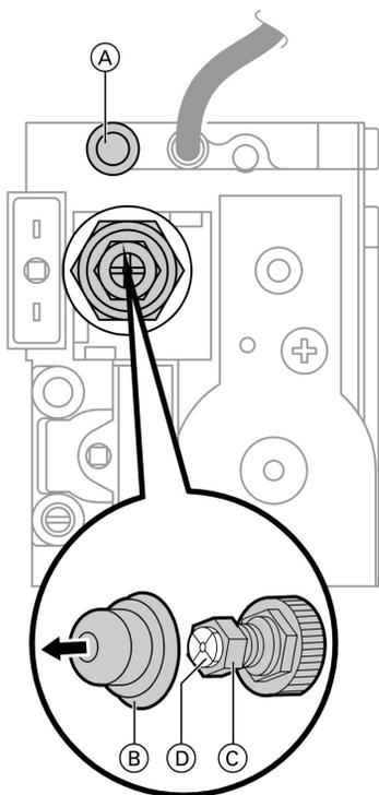
7. Снять колпачок **(B)** с комбинированного газового регулятора.
