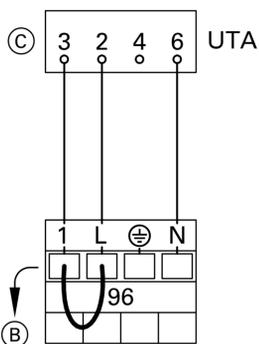
2. Вынуть перемычку (B) на штекере 96 между клеммами "1" и "L".
