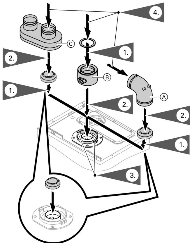
(А) Присоединительный отвод котла для горизонтального монтажа системы отвода отходящих газов (60/100, 70/110 и 80/125).
