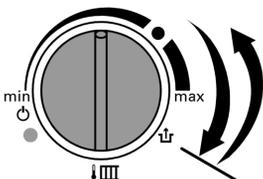
5. Для разблокирования повернуть ручку регулятора "III" почти до отказа вправо и затем обратно. Процесс зажигания повторяется.
