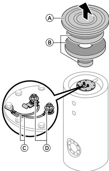
1. Снять крышку (A) и теплоизоляционные маты (B).
