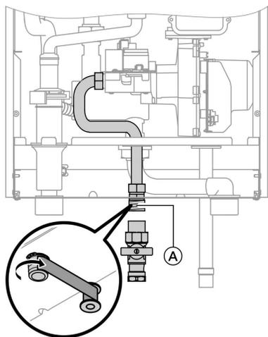
1. Уплотнить запорный газовый кран **A** на патрубке газа.
