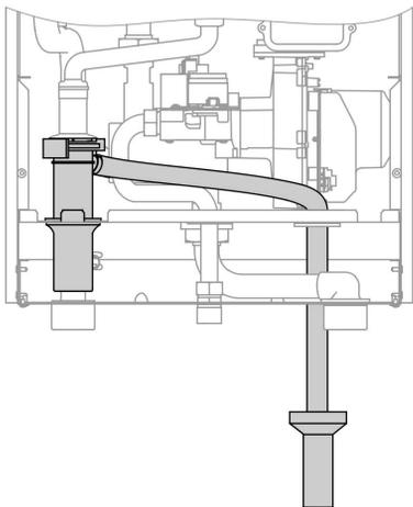
Подключить трубопровод для отвода конденсата в канализацию с созданием уклона и предусмотреть воздушником.
