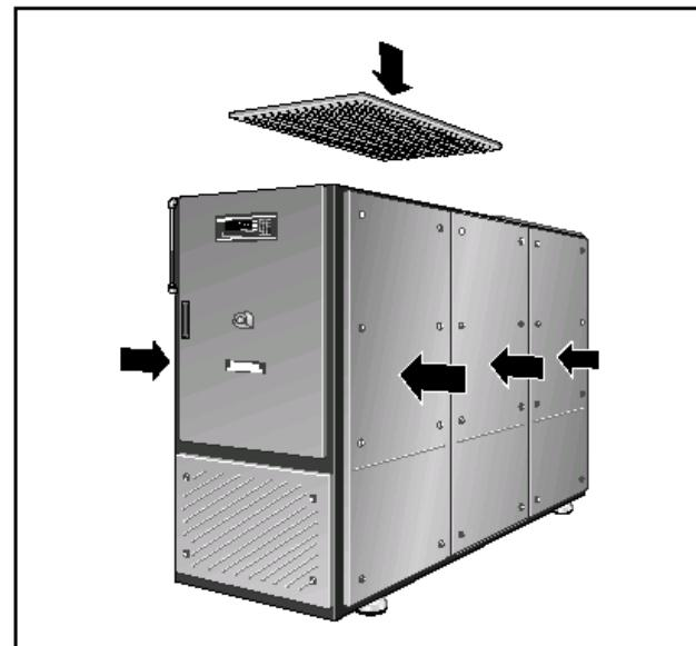
Рис. 13 Монтаж элементов шумопоглощающего кожуха
