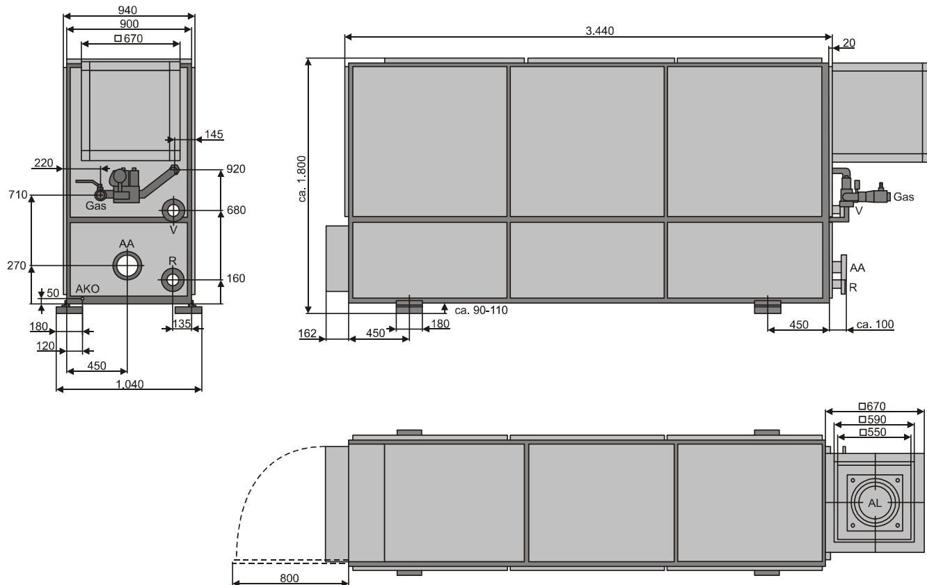
Рис. 1 Габаритные и присоединительные размеры VITOBLOCK 200 EM-140/207 (размеры в мм); Установленный короб вентилятора на задней панели можно демонтировать для транспортировки модуля.
