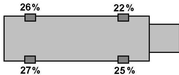
Рис. 3 Распределение нагрузки на опоры
