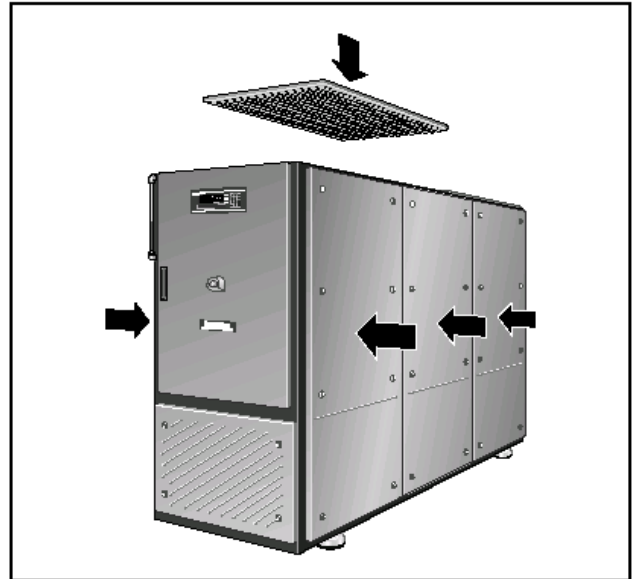
Рис. 13 Монтаж элементов шумопоглощающего кожуха
