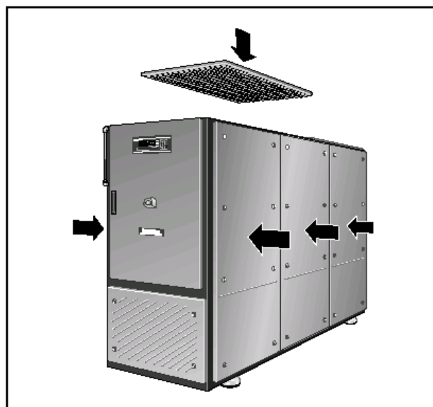
Рис. 13 Монтаж элементов шумопоглощающего кожуха
