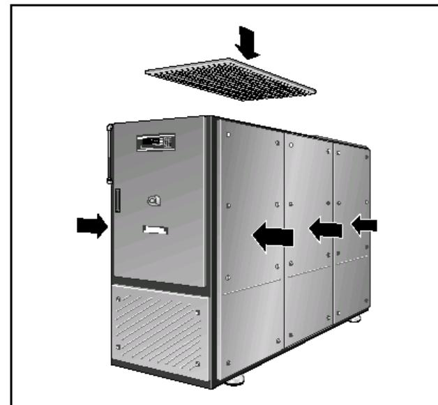
Рис. 13 Монтаж элементов шумопоглощающего кожуха
