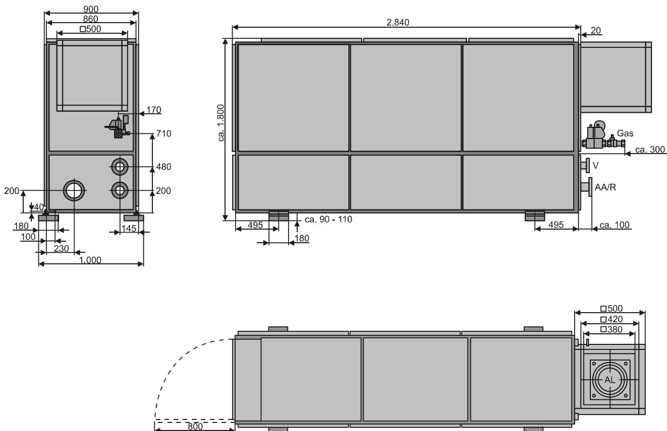
Рис. 1 Габаритные и присоединительные размеры VITOLOC 200 EM-70/115 (размеры в мм); Установленный короб вентилятора на задней панели можно демонтировать для транспортировки модуля.
