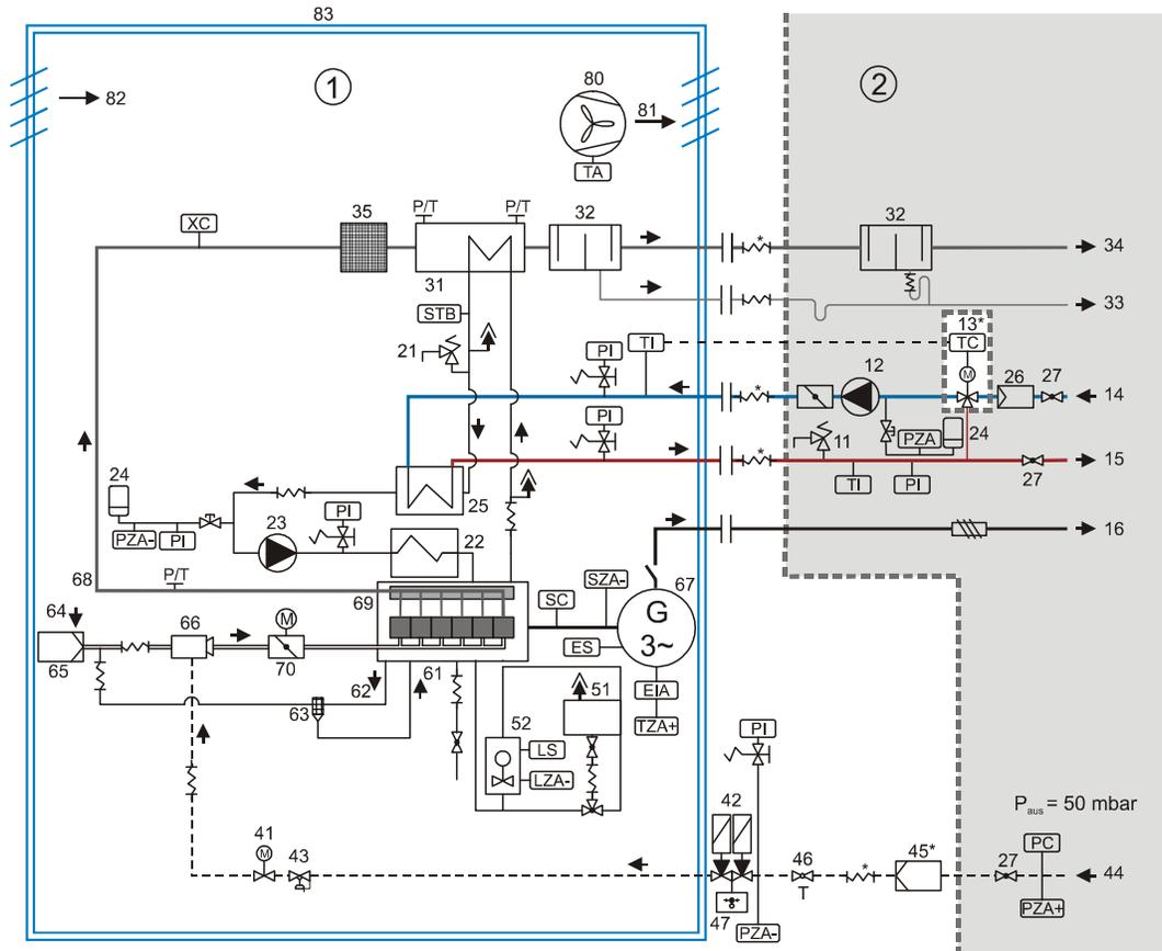
Рис.2 Устройства контроля
