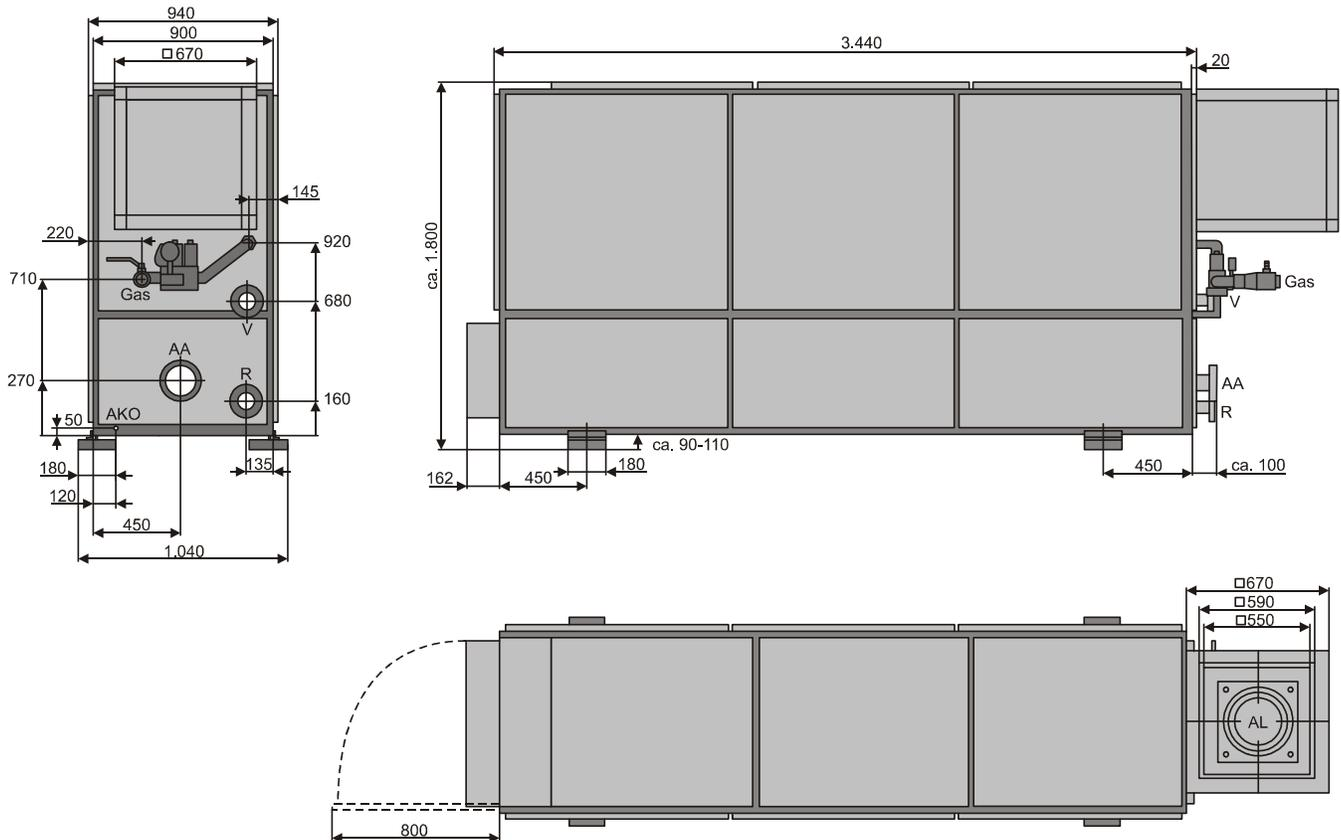
Рис.5 Размеры и подключения VITOBLOC 200 EM-140/207 (размеры в мм);
