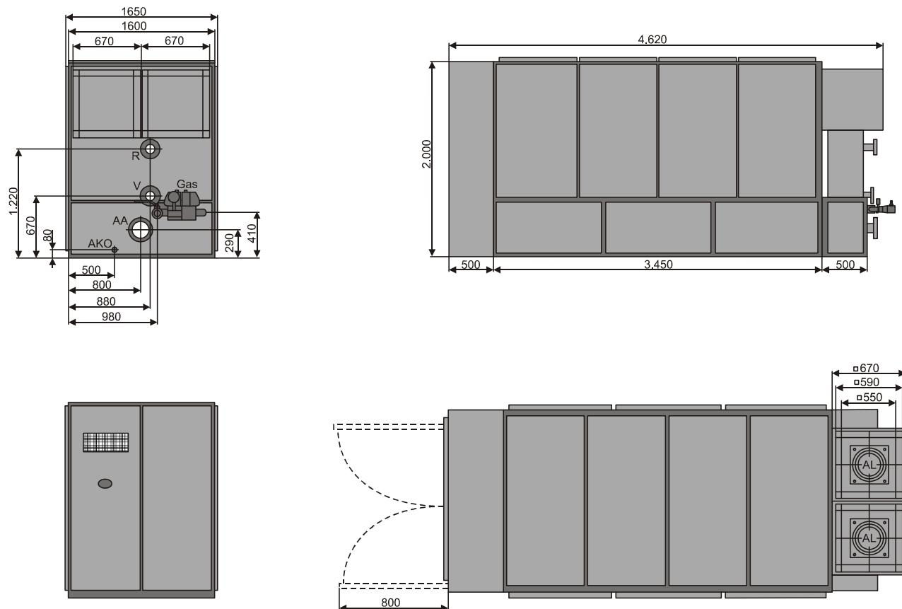
Рис. 5 Размеры и подключения VITOBLOCK 200 EM-238/363 с опциональным кожухом шумоглушения (размеры в мм);
