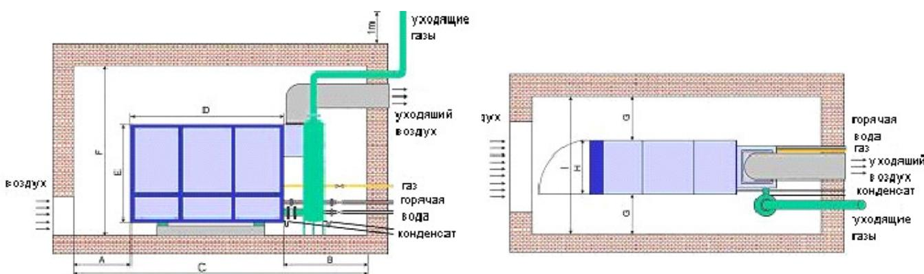
Рис. 6 Пример установки – изображение без арматуры и приборов безопасности (размеры в мм)
