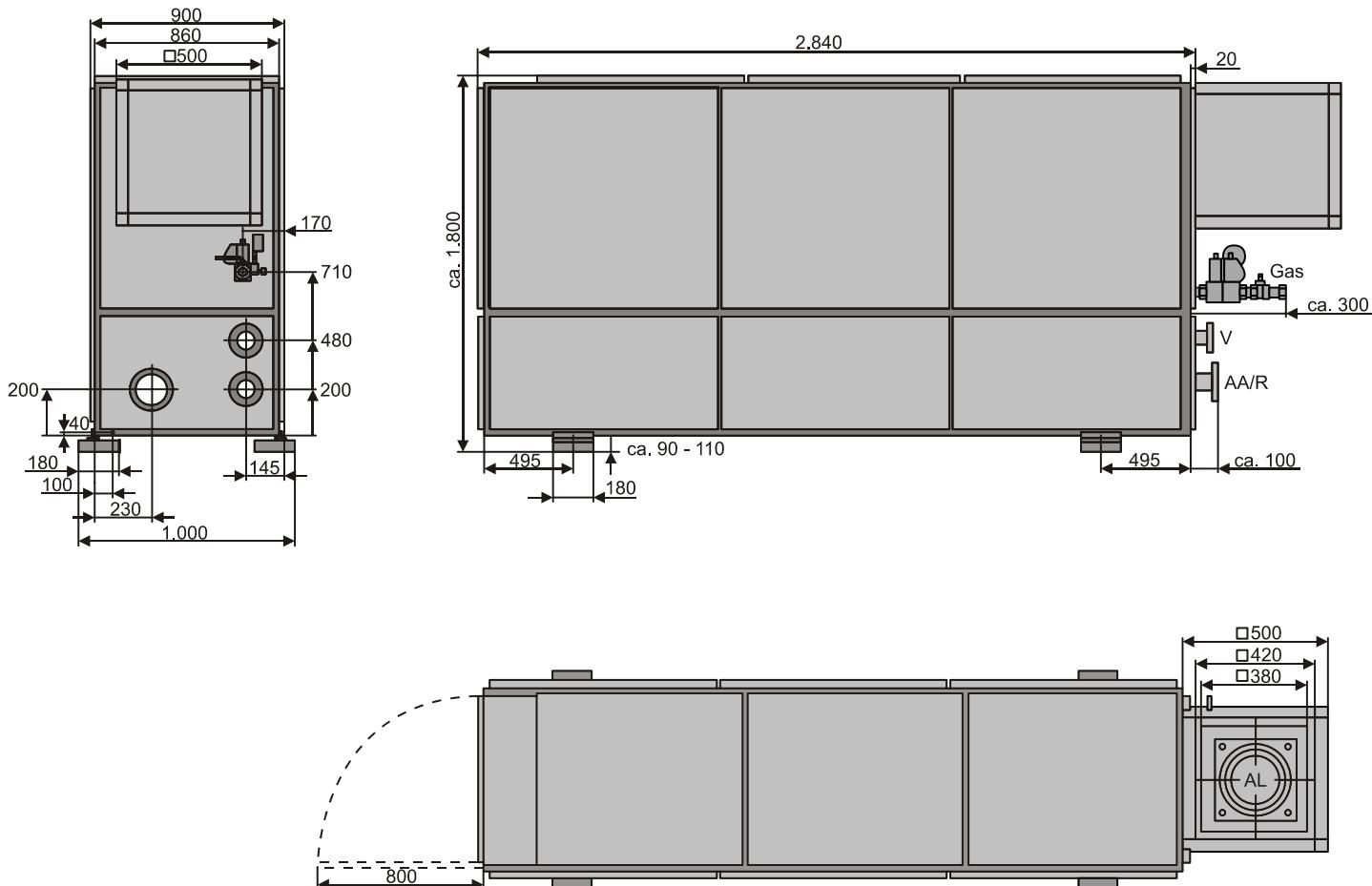
Рис. 5 Размеры и подключения VITOLOC 200 EM-50/81 (размеры в мм);
