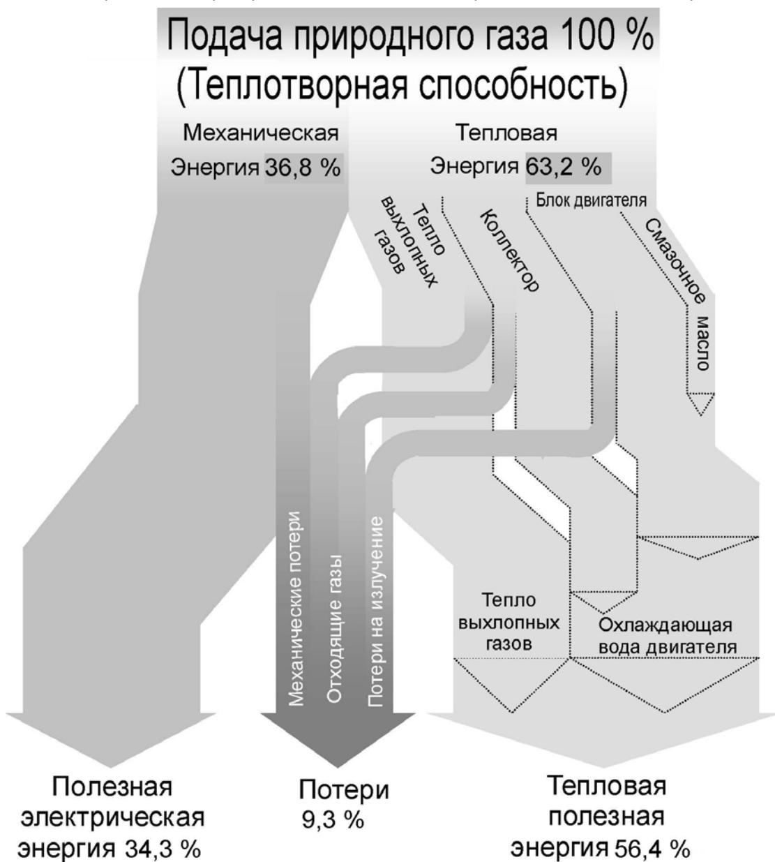
Рис. 1 Энергетический баланс модуля
