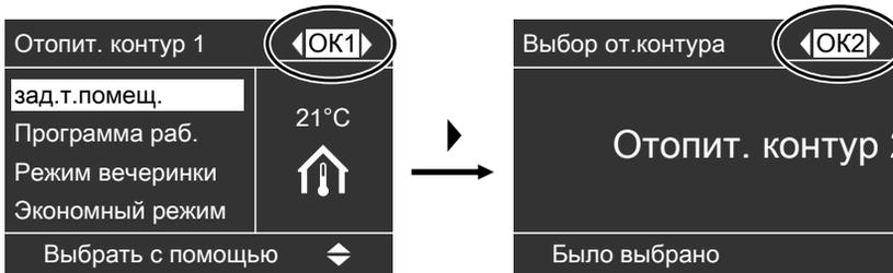
Отопительные/охлаждающие контуры обозначаются изготовителем **"Отопит. контур 1"** (OK1), **"Отопит. контур 2"** (OK2), **"Отопит. контур 3"** (OK3), а отдельный охлаждающий контур - **"Контур охлад. SKK"** (SKK).
