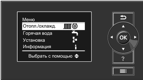
В "Расширенном меню" возможно выполнение и опрос настроек из **редко используемого** набора функций контроллера теплового насоса, например, программы отпуски и временных программ.
