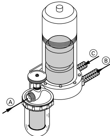
(A) Подводящий топливопровод от резервуара
