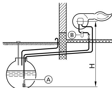
(A) Приемный клапан в нижней части топливного резервуара      (B) Топливный фильтр
