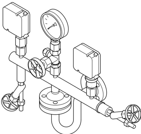
Смонтировать арматурный стержень с устройством ограничения давления на измерительном патрубке проставки для подающей магистрали.
