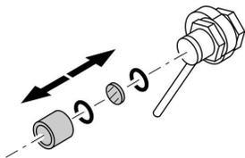
Смонтировать гляделку камеры сгорания (находится в камере сгорания) на крышке камеры сгорания с задней стороны котла.
