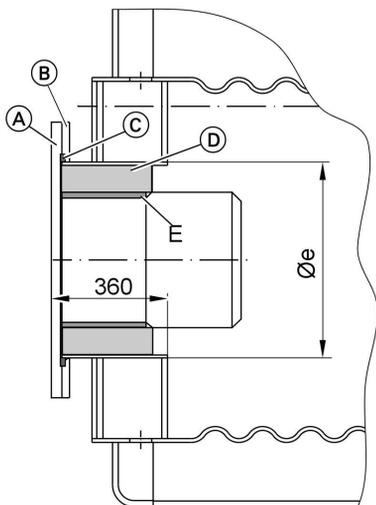
1. Привинтить дополнительную плиту (A) для подключения горелки с уплотнительным кольцом (C) к фланцу котла (B).
