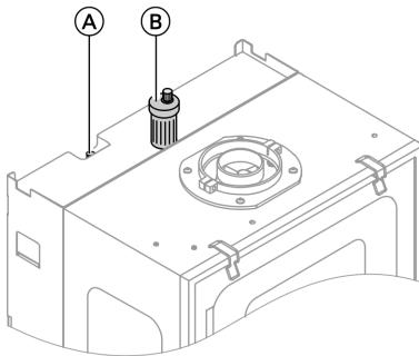
Проверить давление на входе расширительного бака на измерительном ниппеле (A), при необходимости добавить содержимое.
