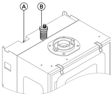
1. Проверить давление на входе расширительного бака на измерительном ниппеле (A).
