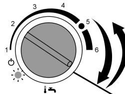
Повернуть ручку регулятора "I III" вправо до упора (оставить на короткое время в этом положении) и затем обратно. Светодиодные индикаторы "I" и "III" одновременно мигают.
