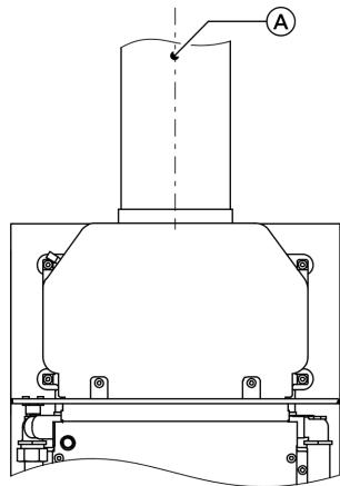
1. Подключить газоанализатор к измерительному отверстию **(A)**.
