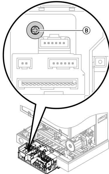
Повернуть потенциометр (B) отверткой влево настолько, чтобы давление газа на жиклере по манометру соответствовало требуемой мощности согласно таблице на стр. 21.
