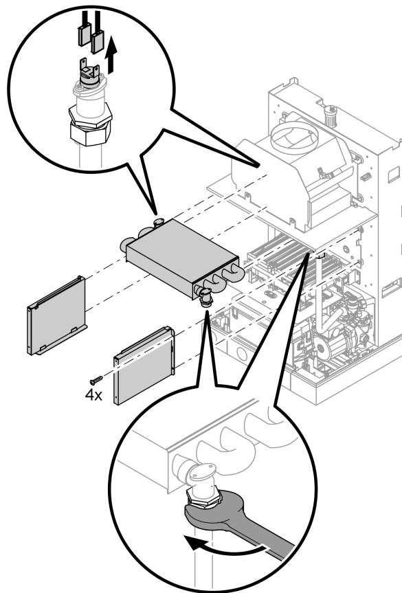
Отпуская резьбовые соединения со стороны греющего контура, придерживать вторым гаечным ключом.
