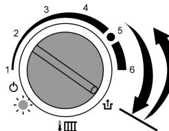
Для деблокирования повернуть ручку регулятора "I III" почти до отказа вправо и затем обратно. Процесс зажигания повторяется.
