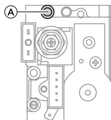
Отпустить, не вывинчивая, винт в измерительном патрубке A и подсоединить манометр.
