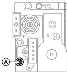
Отпустить, не вывинчивания, резьбовую пробку в измерительном патрубке **(A)** газовой регулирующей арматуры и подсоединить манометр.
