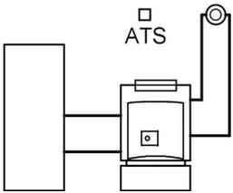
Контроллер погодозависимого цифрового программного управления котловым контуром:
