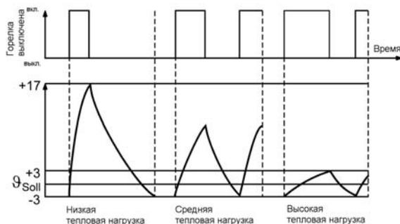
Таким образом, гистерезис переключения, зависящий от тепловой нагрузки, учитывает загрузку водогрейного котла.
