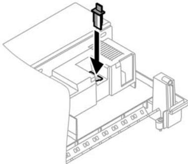
Вставить кодирующий штекер котла через вырез в крышке в гнездо "X7".
