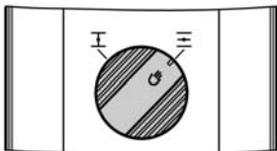
Нажать на поворотную ручку двигателя и одновременно повернуть ее в среднее положение.
