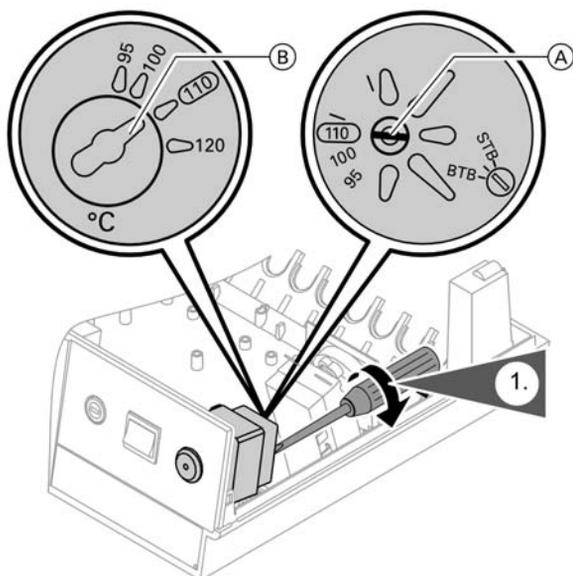
Ⓐ Винт с прорезью в головке на изделии фирмы EGO
