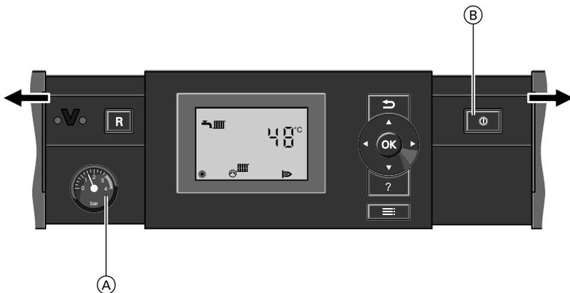
Ⓐ Манометр (индикация давления)
