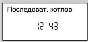
Критерии для последовательности котлов (например, постоянный ведущий котел, последний водогрейный котел) устанавливаются местным специалистом по отопительной технике при вводе отопительной установки в эксплуатацию. В рамках этих критериев возможно изменение последовательности эксплуатации котлов.
