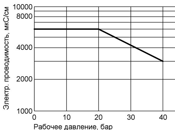
Максимально допустимая прямая электропроводность котловой воды в зависимости от давления (проводимость питательной воды >30 мкС/см)
