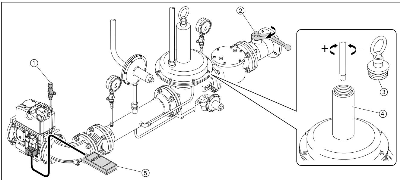
Предварительная настройка давления на регуляторе низкого давления
