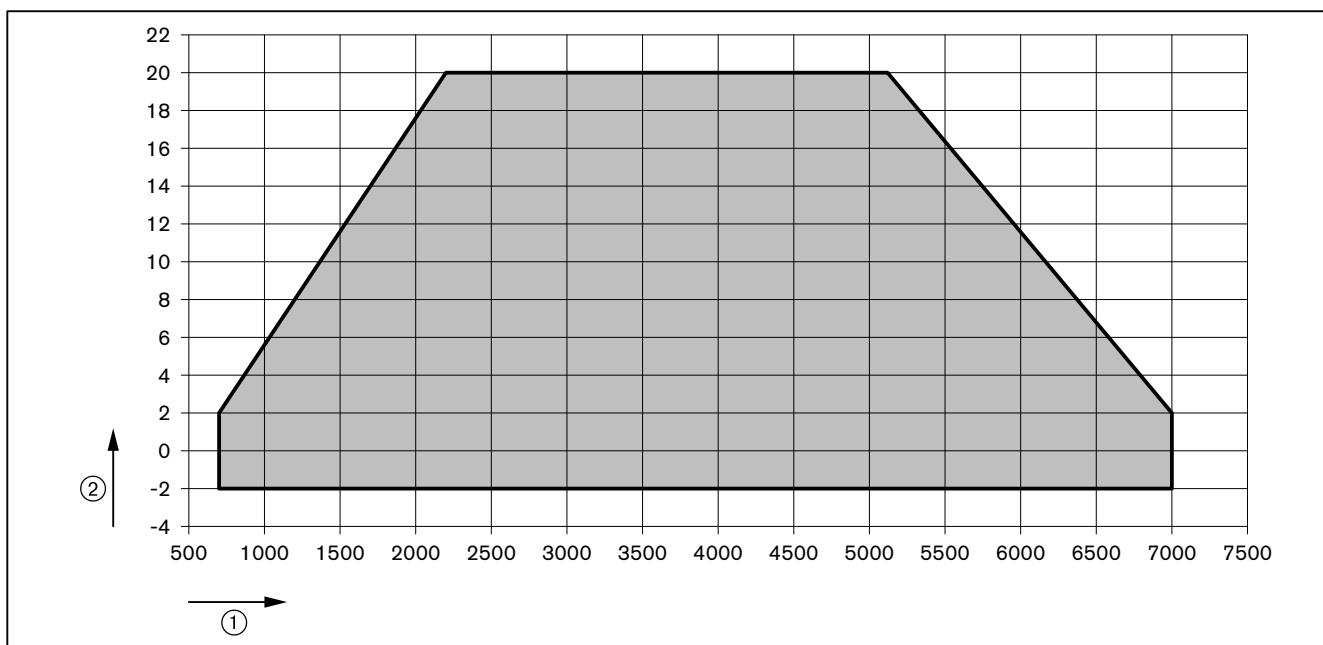
① Тепловая мощность в кВт
